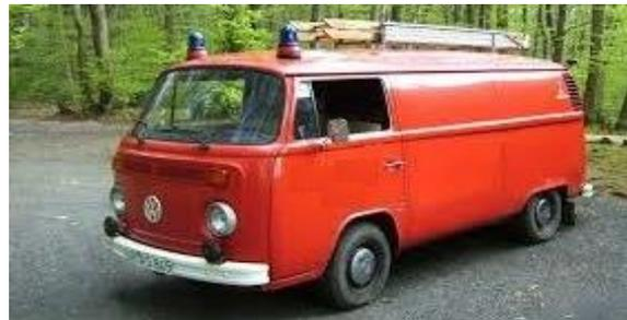
Das betagte Fahrzeug versieht bis zum heutigen Tag noch treu seinen Dienst und ist jederzeit einsatzbereit. Die Beladung ist ausgelegt auf eine Löschgruppe und lässt die Errichtung einer eigenständigen Brandbekämpfung zu. Atemschutzgeräte sind hier nicht untergebracht.
